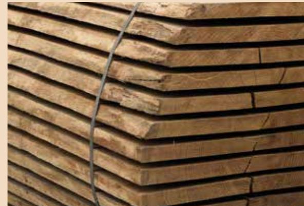
*L'Ottocento* ricerca e seleziona solo l'essenza migliore, con le caratteristiche adatte al proprio metodo produttivo. Il legno massello viene acquistato con una stagionatura minima di 18 mesi, che segue un importante processo di vaporizzazione ed un ciclo di essiccazione con ventilazioni alternate di caldo e freddo. Il risultato è un massello con un grado interno di umidità mai superiore al 10%, con un rischio di movimento e assestamenti ridotto al minimo.
